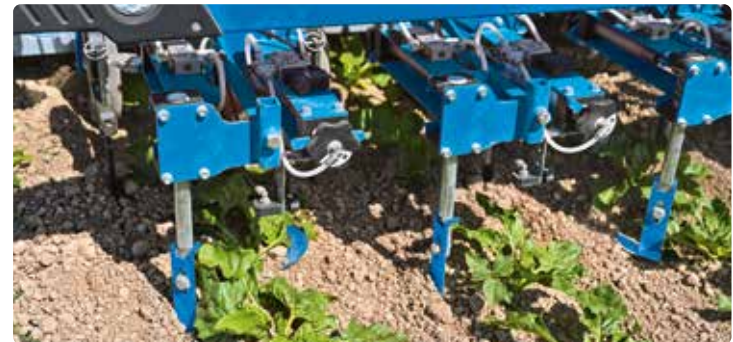
Kameras mit Schutzgehäuse und pneumatische angesteuerte, sichelförmige Hackmesser für jede Reihe
