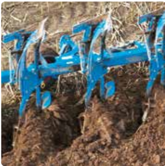
Breitensteuerung am Pflug
