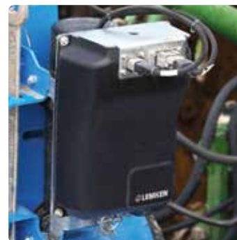
Jobrechner am Pflugturm
