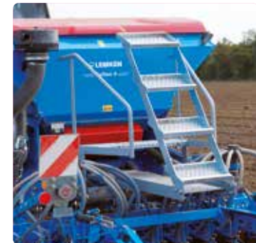
Leichter Zugang bei der Abdrehprobe
