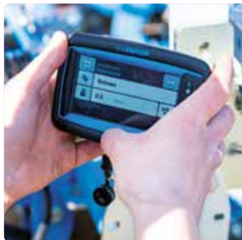
Drillmaschinensteuerung EcoDrill mit Bedienterminal LET-40
