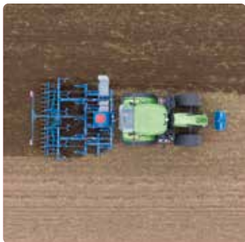
Rahmen mit optimierter Zinkenordnung
