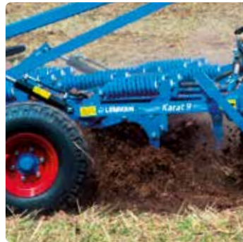
Tiefensteuerung am Grubber
