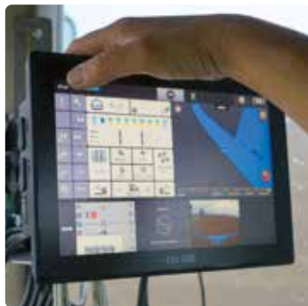
Steuerung mittels CCI 1200 Terminal
