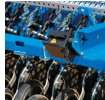
Geschwindigkeitserfassung über Radarsensor (optional)
