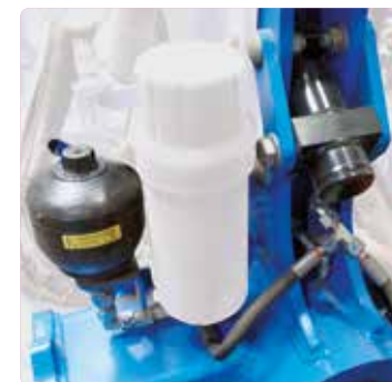
Dämpfungszylinder im Pflugturm
