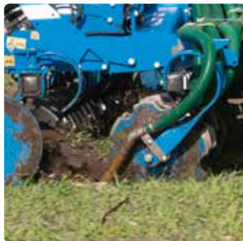
Injektion des Düngers hinter der ersten Scheibenreihe
