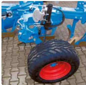
Hydraulische Arbeitstiefen- verstellung
