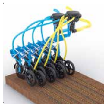
Abb. 2: Zwei Komponenten werden jeweils über ein eigenes Säschar ausgebracht
