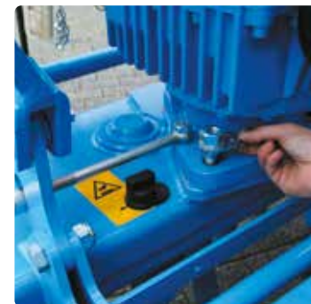
Drehrichtungswechsel für unterschiedliche Einsatzbedingungen
