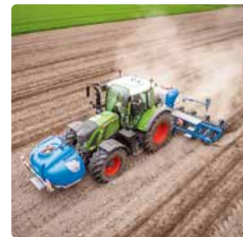
Flüssigdüngerapplikation mit der Azurit 10
