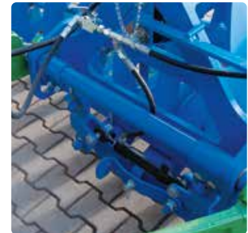
Hydraulische Vospannung der Lenkung
