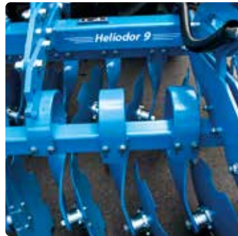
Scheiben im Bereich der Traktorspur separat einstellbar
