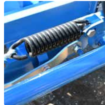
Mechanische Vospannung der Lenkung
