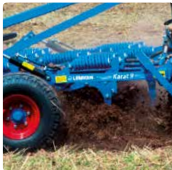
Tiefensteuerung am Grubber
