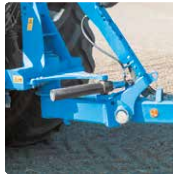
Pflugturm mit OptiLine Einstellsystem
