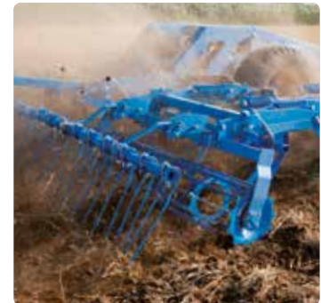
Nachlaufende Kombination aus Walze und Striegel
