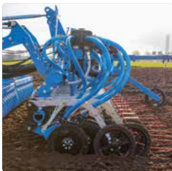
Verteiler über der Säschiene
