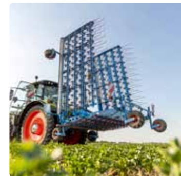
Angeklappte Zinken sorgen für einen sicheren Straßentransport
