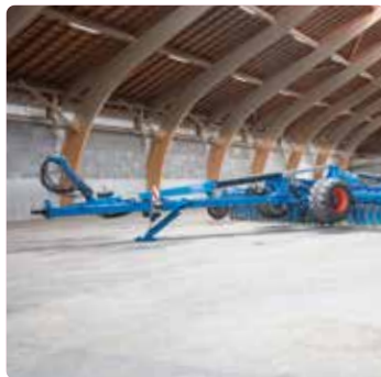
Anhängung über Kugelkopf oder Zugöse
