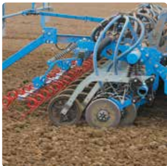
Das OptiDisc Doppelscheibenschar hydraulisch bis 70 kg Schardruck
