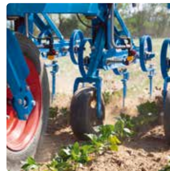
Bandspritzung mit dem EC-Weeder
