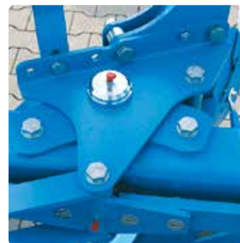
Hydraulisch einstellbare Arbeitsbreite (nur Titan 18 V)
