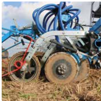
Das OptiDisc Doppelscheibenschar mechanisch bis 45 kg Schardruck
